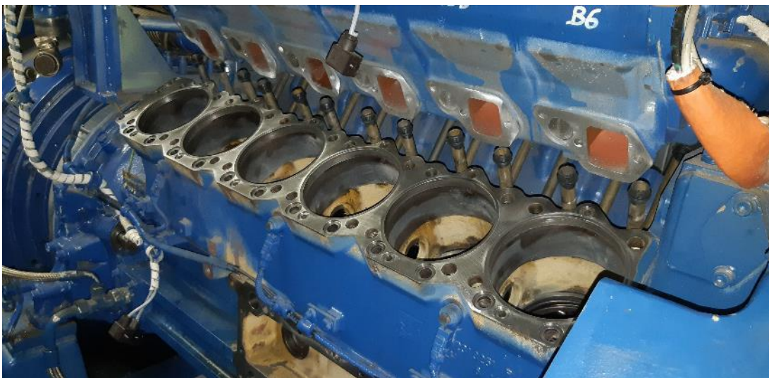
Démontage des culasses
